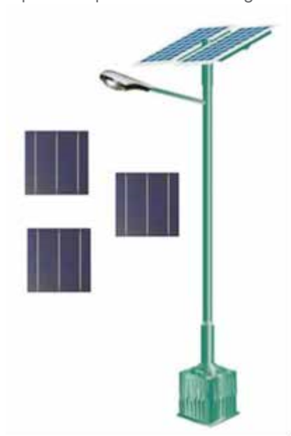
Fig. 13 : Lampadaire qui utilise de l'énergie solaire photovoltaïque [9]
