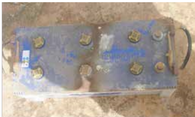
Fig. 1. État possible des batteries
